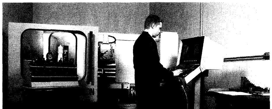
Abbildung 5: Computergestützte Produktion der Spritzgieß-Werkzeuge an Bearbeitungszentren im Formenbau.
